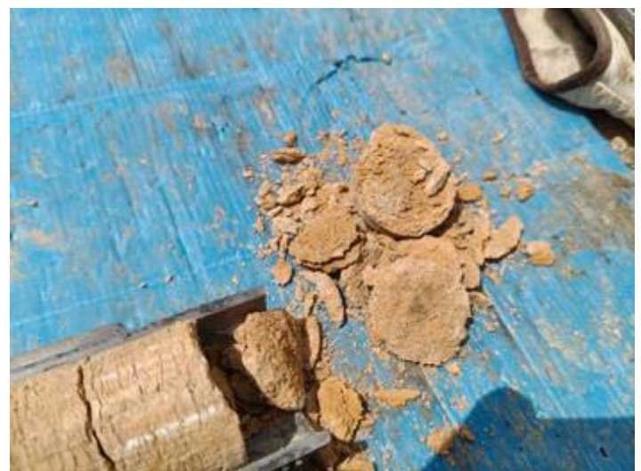
Vistes dels materials del subsòl extrets en tres assaigs SPT realitzats al llarg del sondeig S-2.
