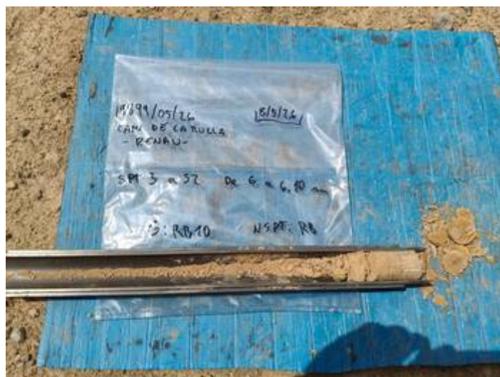
Vistes dels materials del subsòl extrets en tres assaigs SPT realitzats al llarg del sondeig S-2.
