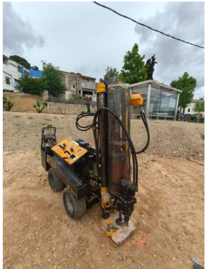
Vistes de dos dels tres sondeigs realitzats a la zona objecte d'estudi, S-3 del tipus Rotació helicoidal i P-2 del tipus DPSH.
