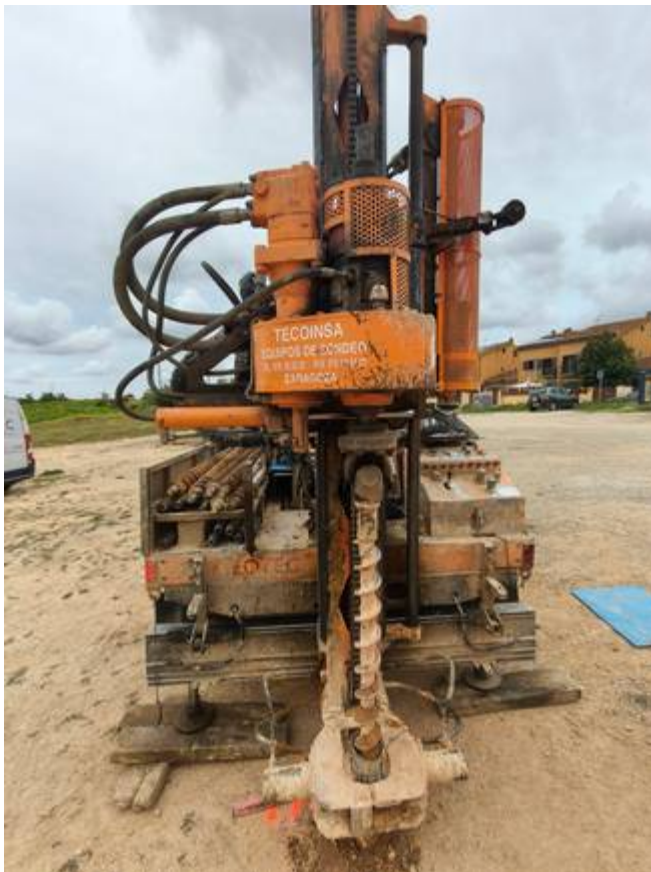
Vistes de dos dels tres sondeigs realitzats a la zona objecte d'estudi, S-3 del tipus Rotació helicoidal i P-2 del tipus DPSH.
